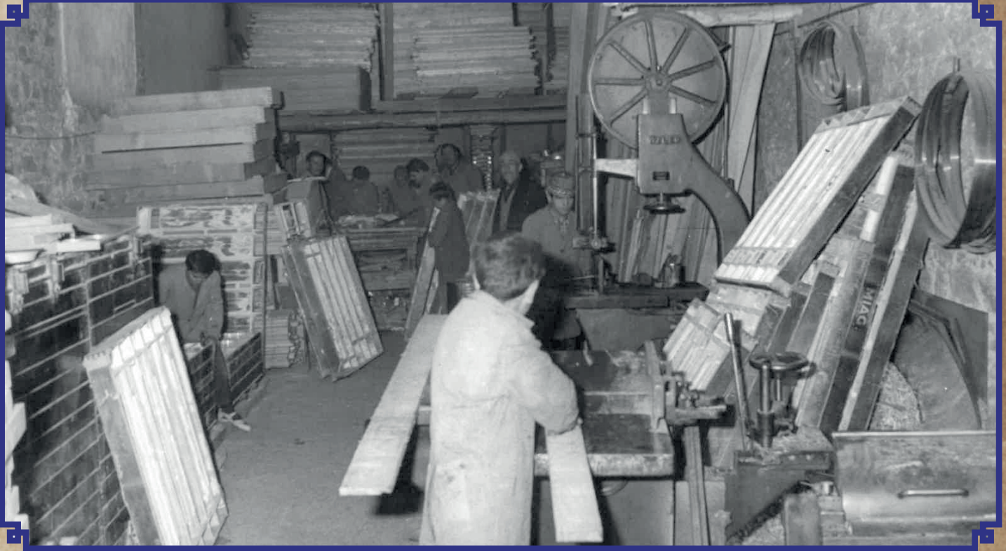
1970'li yılların başında Larende Caddesi'ndeki bir atölyede un fabrikalarına ait eleklerin imalatından bir fotoğraf.
